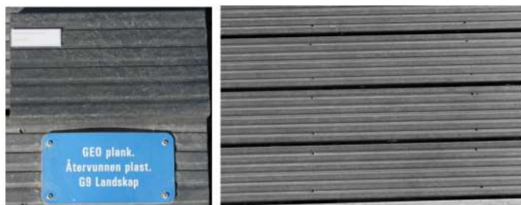
Figur 25. GEO plank G9 Landskap, återvunnen plast.
